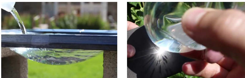
Obr. 12. 1: Príklad vytvorenia hrubej šošovky
