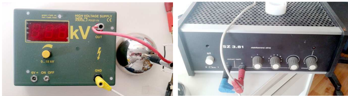
Obr.4. 6: Vľavo: školský vysokonapäťový regulovaný zdroj 0 – 18 kV. Vpravo: školský laboratórny zdroj 0 – 30 V
