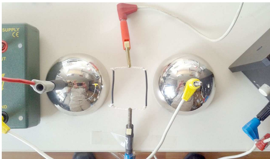
Obr.4. 5: Celková zostava. Namiesto platní sme použili kovové polgule zo školskej stavebnice pre elektrostatiu. Rámik bol vo vzduchu držaný prírodnými vodičmi.
